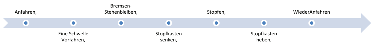
Abbildung 1: Prozesskette des Gleisbaus
